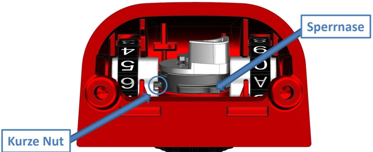
Linkes Zahlenrad drehen, bis die **kurze Nut** des Zahlenrades über der Sperrnase des Drehknopfes steht
