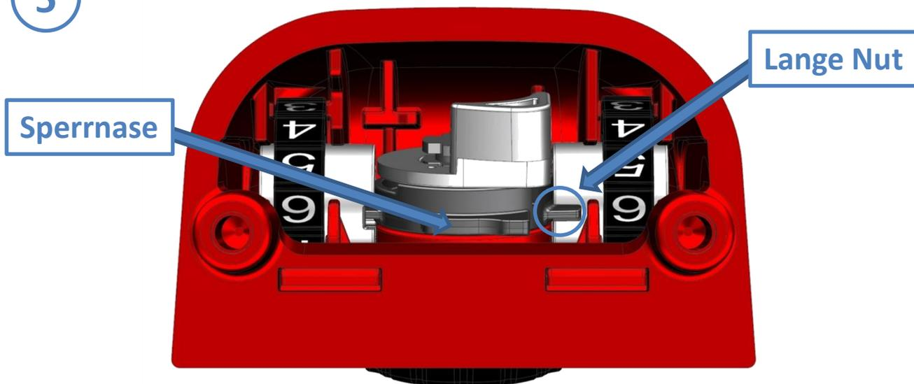
Rechtes Zahlenrad drehen, bis die **lange Nut** des Zahlenrades über die Sperrnase des Drehknopfes steht
