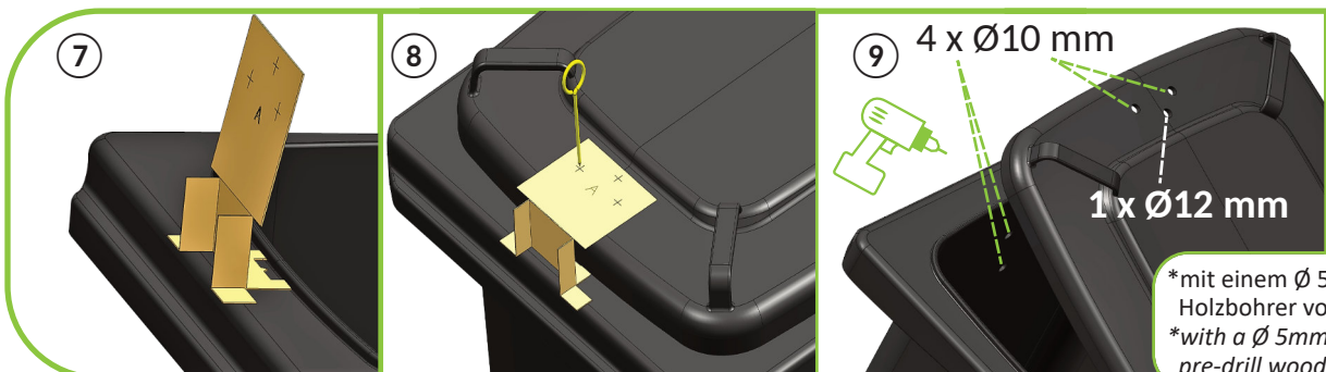
Schablone A falten und an Markierung aufstellen Fold template A and place at marking
